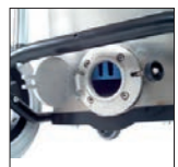
Clapet de nettoyage et de vidange
