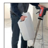
Montage simple du réservoir à lessive
