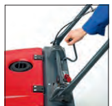
Hebel Seitenbesen absenken / anheben
