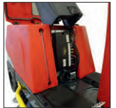
Integriertes Ladegerät und einfacher Zugang zur Elektronik
