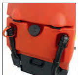
Leicht zugängliches Batteriefach sowie Füll- und Entleerschläuche
