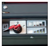
Batterie- und Onboard Ladegerät Anzeige inkl. Tiefentladeschutz
