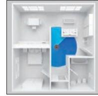
Automatische Raumkartierung, virtuelle Wände und Lasernavigation (LiDAR)
